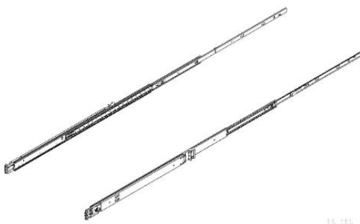
Рис 5.1 – Подготовка направляющих к установке
