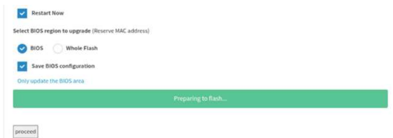
Рис 10.3 – Запуск процедуры прошивки
