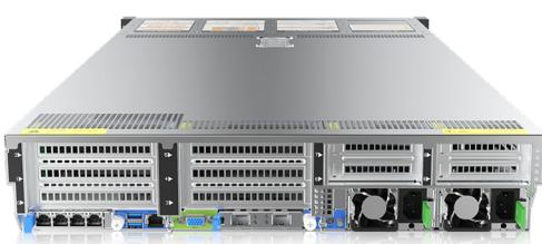
Сервер предназначен для размещения в стойке и имеет размер 2U, сконструирован на принципах отказоустойчивости, расширяемости и удобства обслуживания и минимизации времени простоя:
