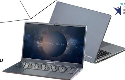
INFERIT у с диагональю экрана 15,6 дюймов и разрешением Full HD (1920x1080) оснащен процессором Intel i5-1334U из серии Raptor Lake-U с десятью ядрами и двенадцатью потоками.
